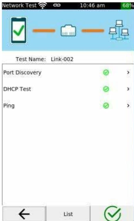
I test automatici in modalità Ethernet elencano tutti i test della rete collegata.
