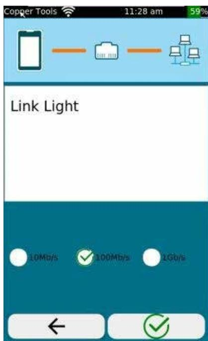
Per identificare il LED di collegamento dello switch, LinkXpert può far lampeggiare il LED di collegamento della porta dello switch. A tal fine, LinkXpert deve essere collegato a uno switch tramite l'interfaccia in rame o in fibra.
