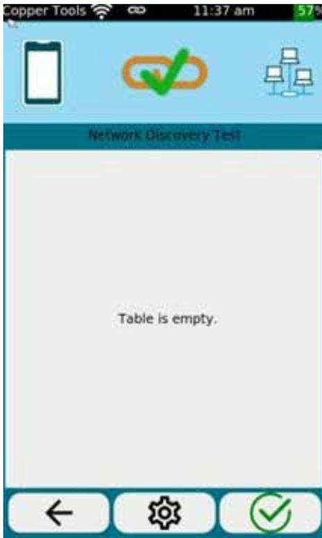
Nel test di Network Discovery, LinkXpert elenca tutti i nodi di rete visibili nel range specificato.
