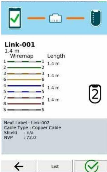
Nel modulo di test del cablaggio, il dispositivo visualizza lo schema di cablaggio con le lunghezze.
