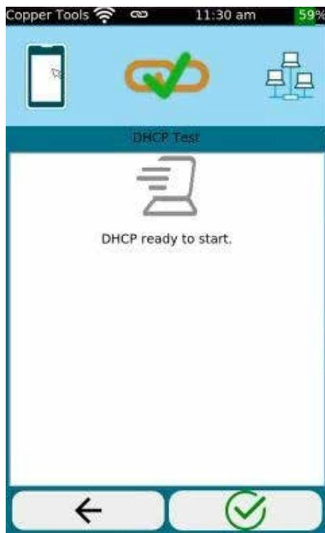
Durante il test DHCP, LinkXpert verifica se al dispositivo può essere assegnato un indirizzo IP dalla rete e se vengono trasmesse altre informazioni come l'indirizzo del server DNS e l'intervallo di indirizzi.
