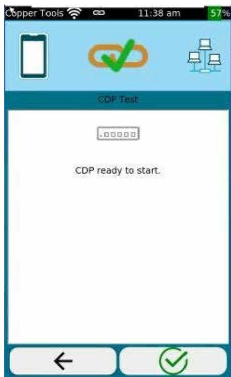
Nel test CDP “Cisco Discovery Protocol”, LinkXpert elenca i responsi CDP dello switch connesso.
